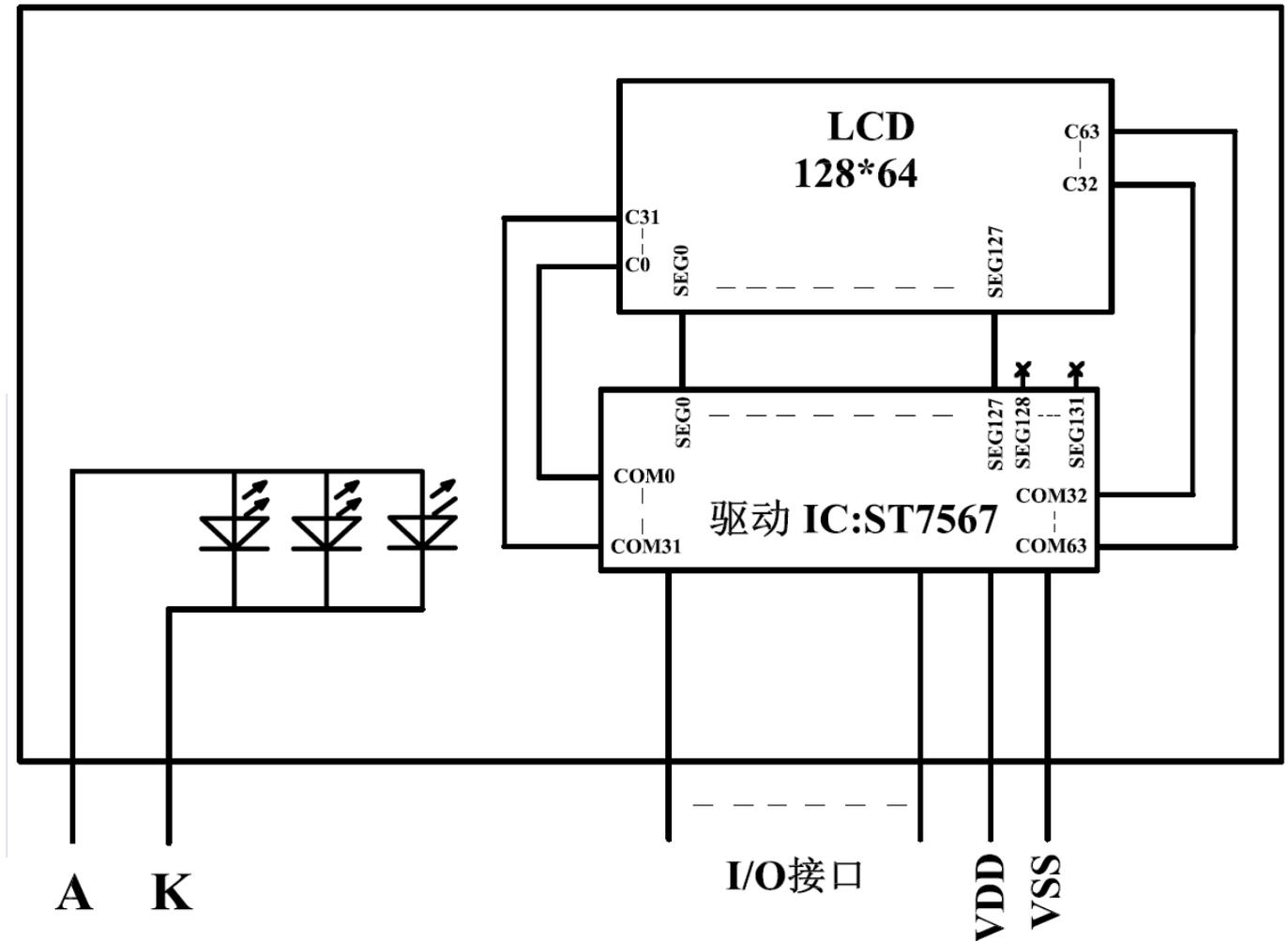
图 2: JLX12864G-332 图像点阵型液晶模块的电路框图
