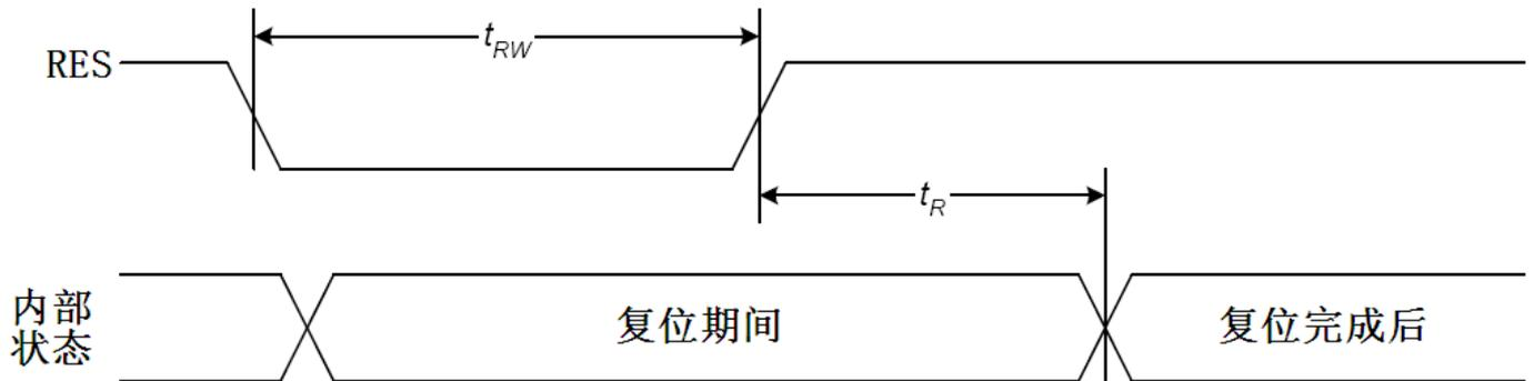
图 6: 电源启动后复位的时序
