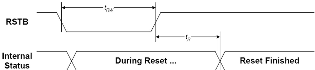
图 5: 电源启动后复位的时序
