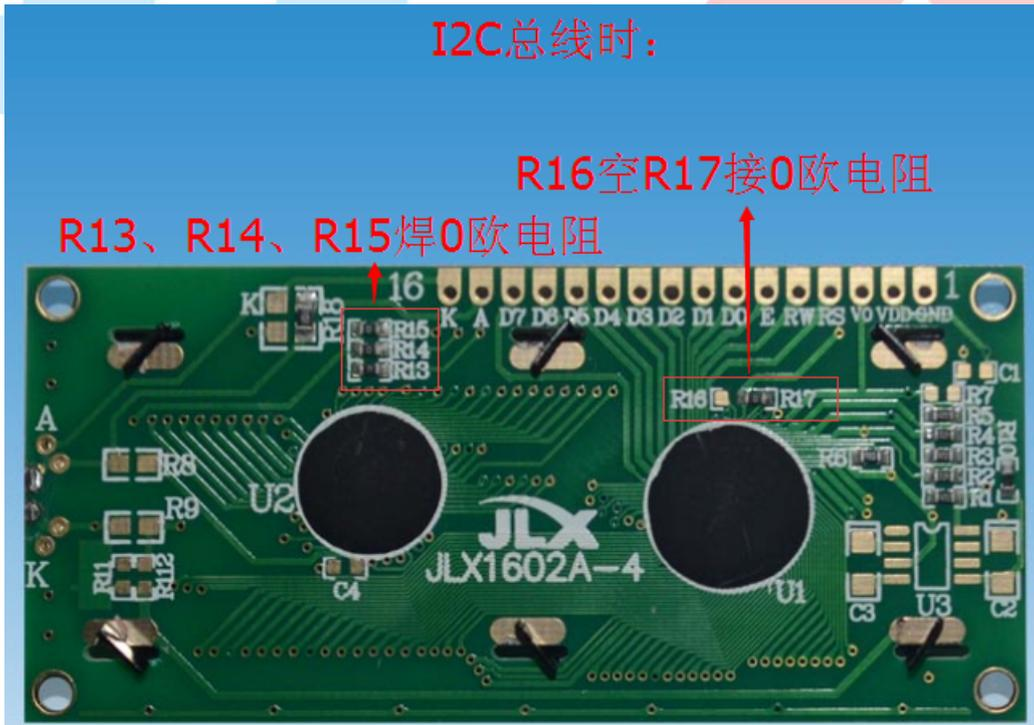
IIC 总线时 PCB 的电阻接线方法（R16 空 R17 接 0 欧；R13\R14\R15 全都接 0 欧）
